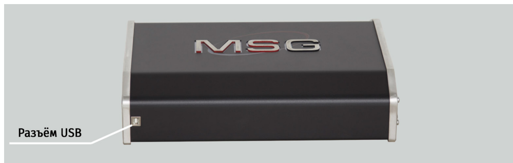
Рисунок 2. Расположение USB разъема на корпусе тестера
