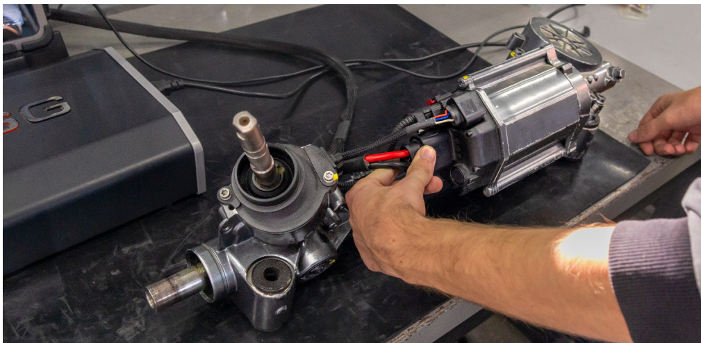
Рисунок 3. Подключение агрегата ЭУР к тестеру
